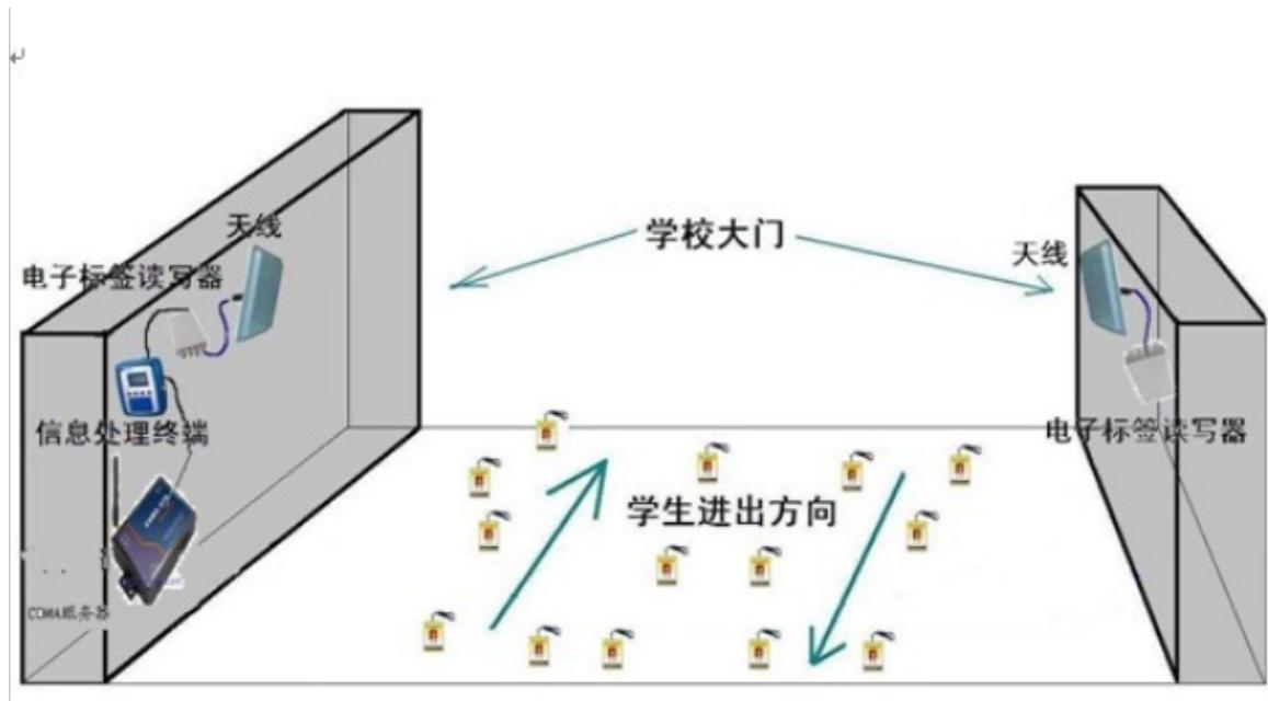
目前市场上的远距离读卡器有感应距离由几十米远到1米远的各种读卡器，几十米远用来做人员识别显然是不能用的，不可能让人才走到离通道口几十米远的地方就被识别出来，因为人员可能刚巧从旁边经过而不是要进入通道，所以工程安装人员在实施的过程中就要对这个感应距离进行调整，但往往得不到一个合适的距离，因为卡片在不同的角度被读取的距离变化很大，而调节的信号变动范围很大，卡片正对着天线的时候距离在6米，垂直于天线的时候可能只有1米甚至是读不到，比如做一座学校校门口的人员识别，会出现人员只是在教学楼内走动却错误的被读到卡片判断为外出的情况。盐城价格低且质量高的远距离考勤机远距离考勤自动识别靠谱厂家，致电上海新校源电子科技有限公司。
